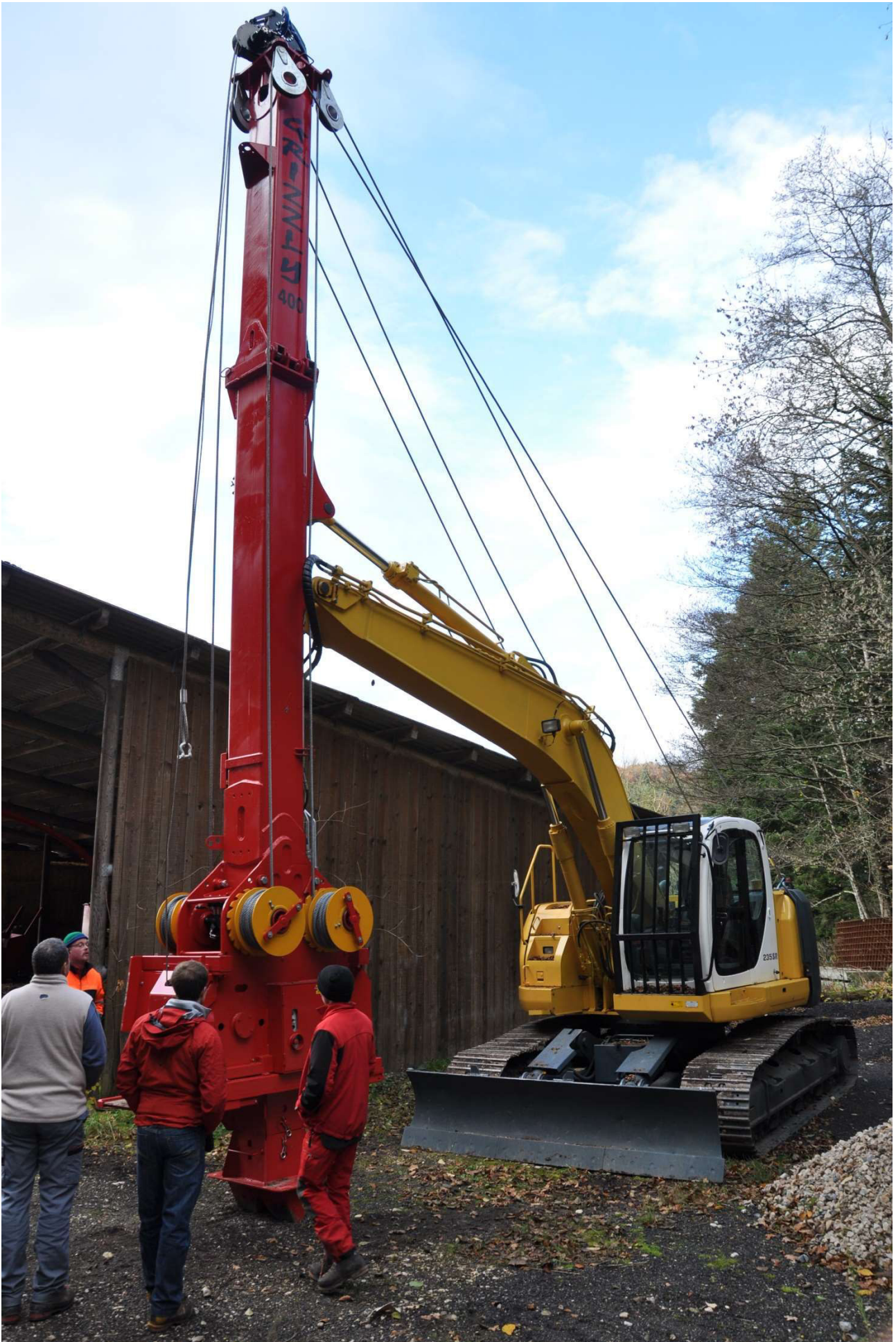
Abb. 7 Forstmaschinen im Einsatz – Yarder Seilkrangerät
