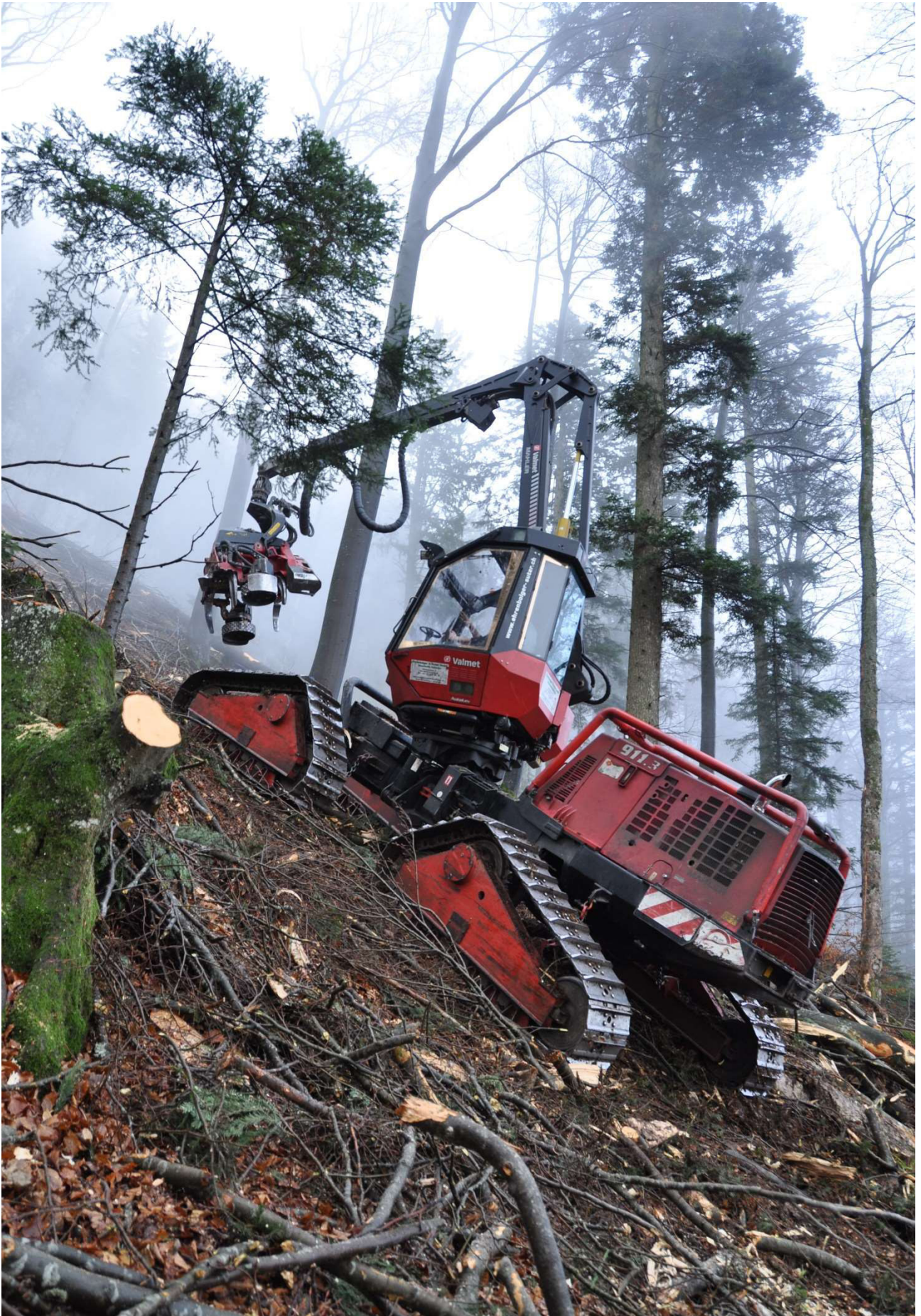
Abb. 6 Forstmaschinen im Einsatz - Raupenharvester
